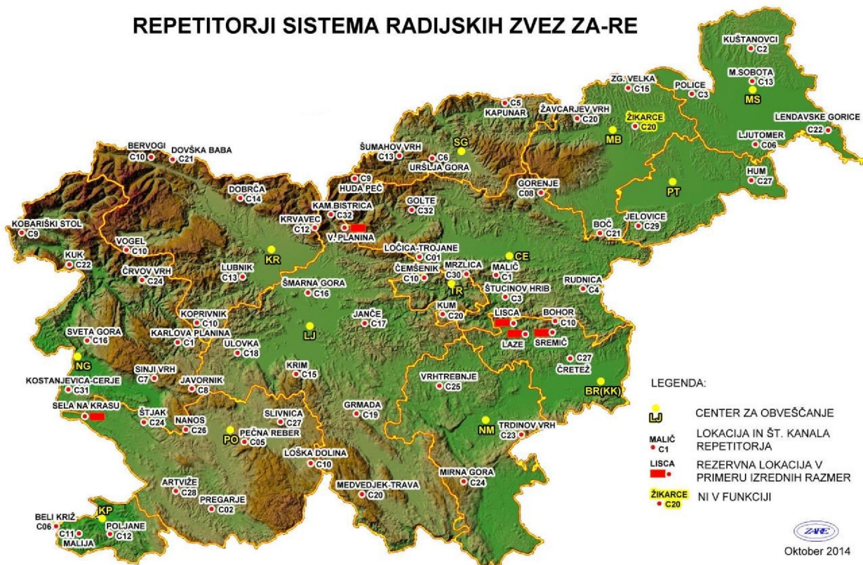
Slika 3: Repetitorske postaje s kanali sistema ZA-RE
