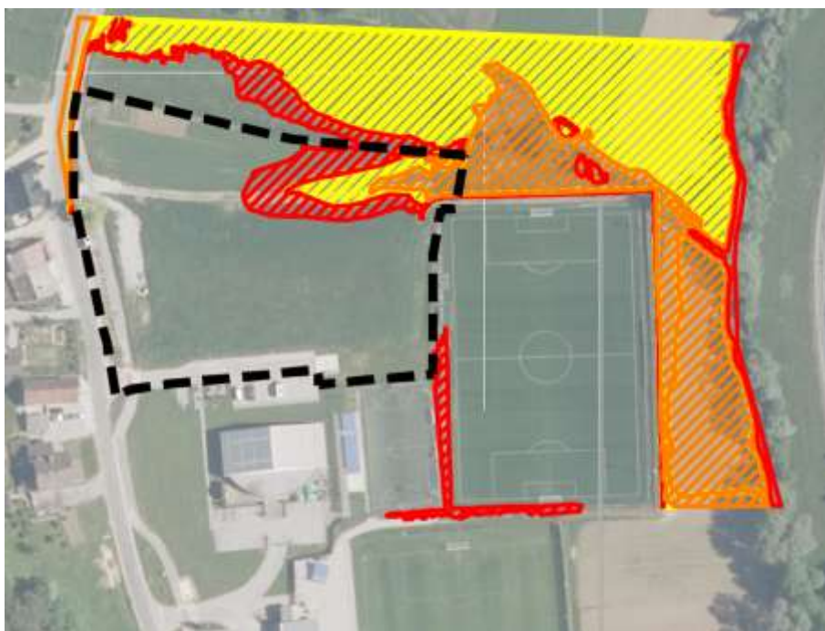
Slika 7: prikaz razredov poplavne nevarnosti (vir: zgoraj citirana hidrološko hidravlična analiza)
